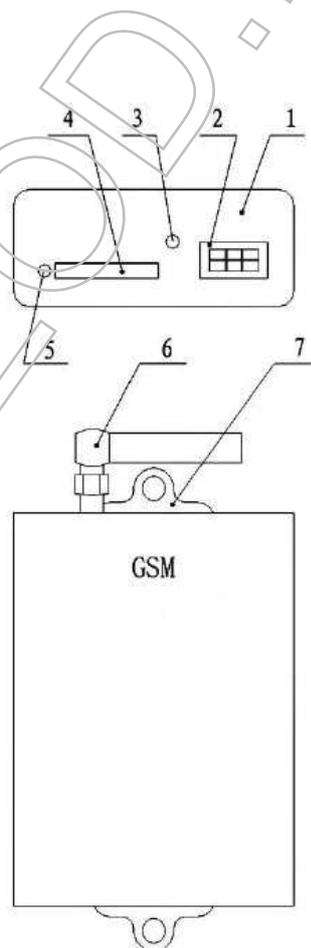
1 - корпус 2 - разъем 3 - индикатор работы сети (двухцветный) 4 - адаптер для SIM карты 5 - кнопка установки SIM карты 6 - антенна 7 - рёбра для установки
