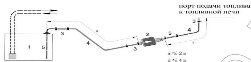
1 - бензобак 2 - топливный насос 3 - соединительная топливная трубка
